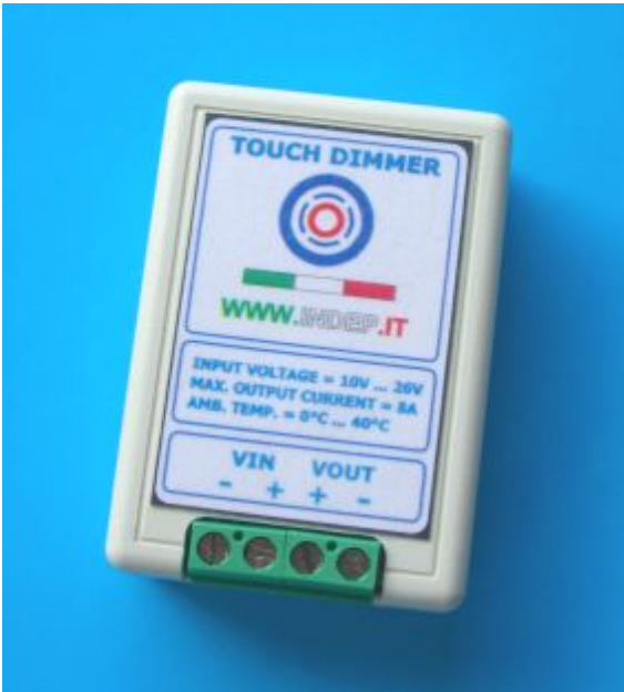
Dimmer in tecnologia Touch - modello IDP750B. Applicazione con strisce led.
