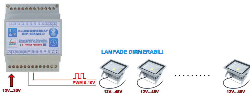
Centralina BLUEDIMMERDAY HM con lampade aventi dimmer integrato (esempio con solo 1 canale).
