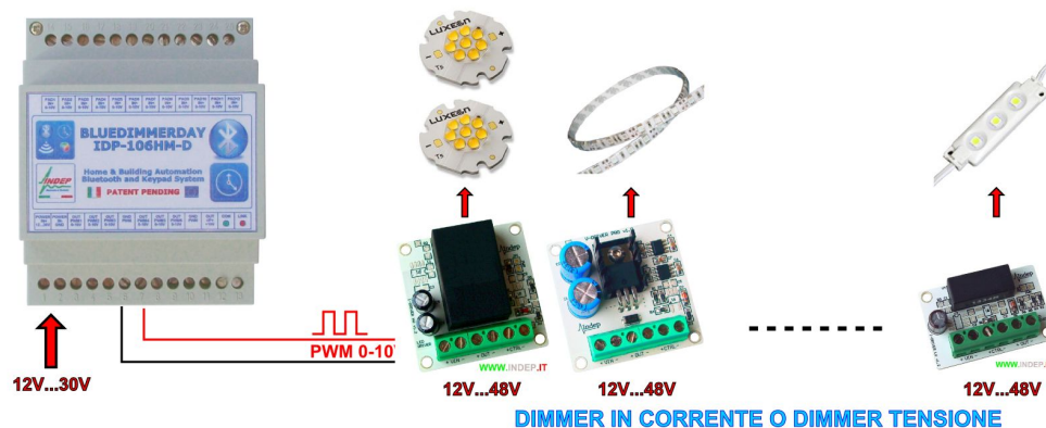
Centralina BLUEDIMMERDAY HM con nostri moduli dimmer (esempio con solo 1 canale).
